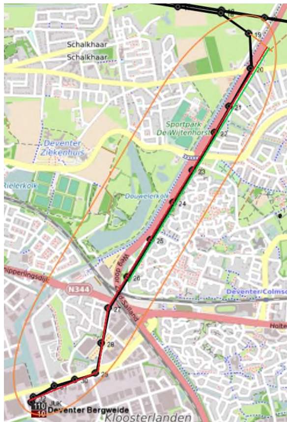
Figuur 1.2 | Onderzoeksbied (Oranje) Mogelijke verkabelingen 110 kV-hoogspanningslijn langs Vijfhoek en door Snipperling te Deventer (DVPB110 tot mast 20 (rood); deel tussen mast 26 en 20 (alleen langs wijk Vijfhoek groen).
