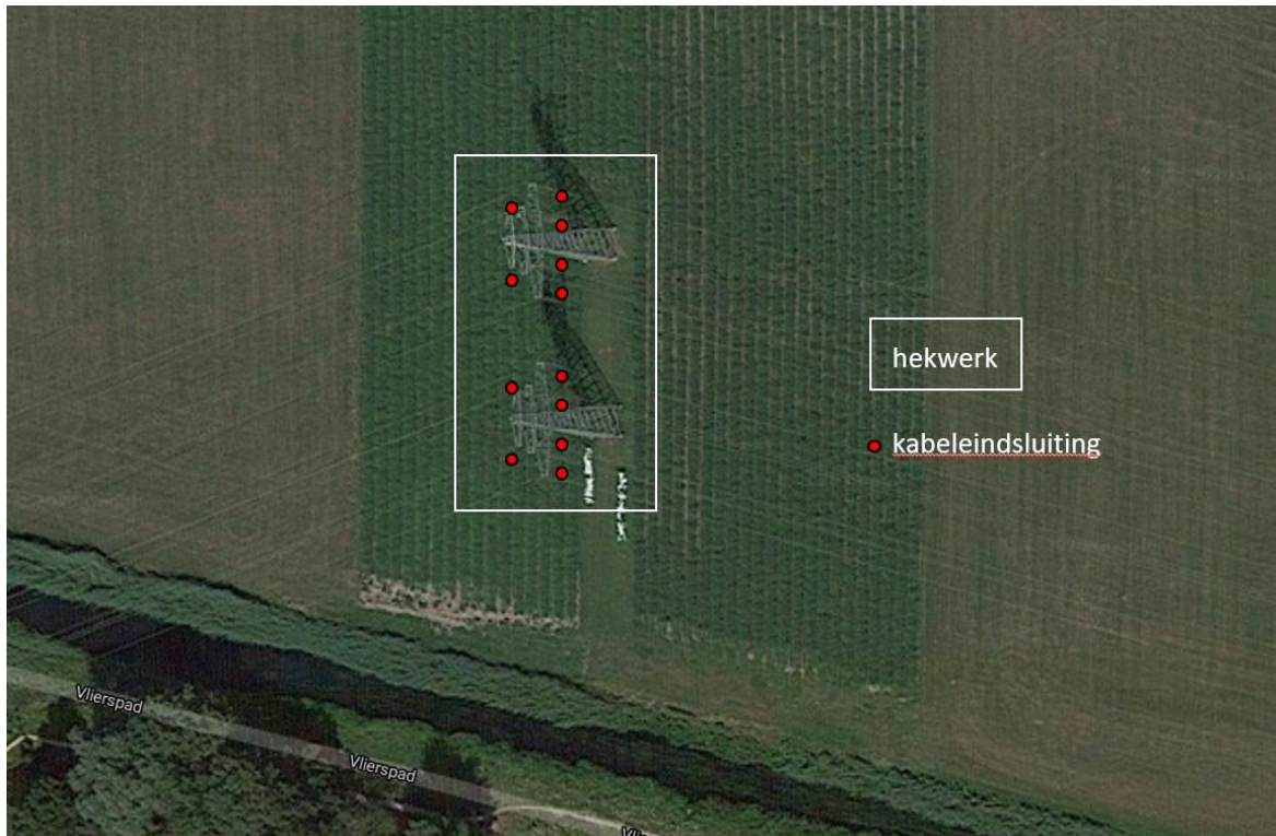
Figuur 1.14 | Situatie bij mast 4 in de lijn naar Rijssen, Goor en Deventer Bergweide. De rode stippen geven de positie van de kabeleindsluitingen weer, de witte lijn is positie van het hekwerk rondom de masten en de installaties.
