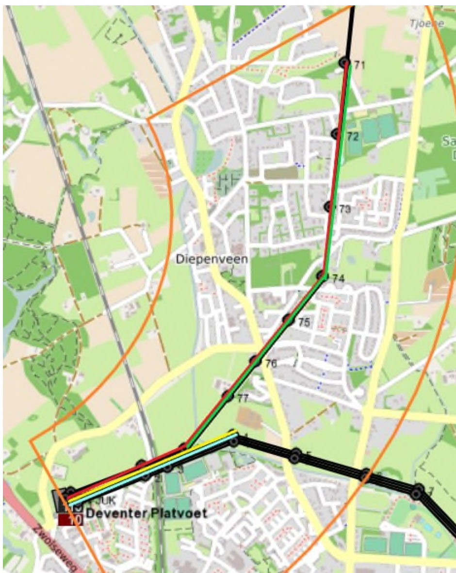
Figuur 1.2 | Onderzoekgebied (oranje vlak) mogelijke verkabelingen 110 kV-hoogspanningslijn door Diepenveen te Deventer (DVTP110 tot mast 71 (rood); deel tussen mast 78 en 71 (alleen dorp Diepenveen groen), tot aan masten 4 (omdat het hoekmasten betreft (geel, richting Rijssen en Goor en lichtblauw richting DVTB).
