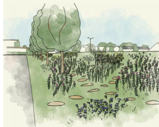
Afbeelding 18: 'Golftegel' wordt toegepast om het trottoir te verlagen op plekken waar regenwater vanaf de weg het groen kan inlopen om daarmee wateroverlast te voorkomen en verdroging van het groen tegen te gaan.
