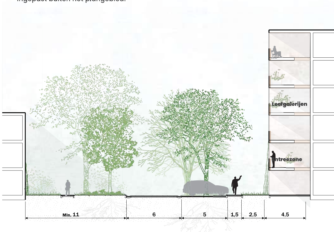
Basisprofiel ontsluitingsstraat (schaal 1:200) - maatvoering indicatief
